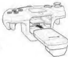
**Nota:** quando viene inserito nello presa di espansione 1 del controller Dreamcast, il Vibration Pack si collega, ma non si blocca. Se il controller viene urlato, il Vibration Pack può scollegarsi durante il gioco e comprometterlo.
